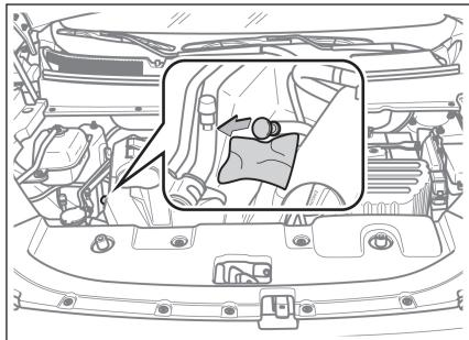
2. 在机油尺端部下方放一块抹布，拉出机油标尺。
