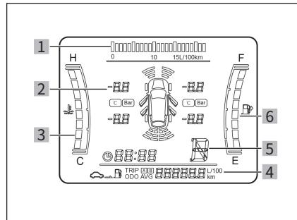
整车电源处于“ON”状态时，显示发动机冷却液的温度。在C~H的指示范围内共有8段刻度指示，其中“C”表示冷(低温)，“H”表示热(高温)，根据不同温度点亮相应的格数。当水温表点亮第7段刻度指示时，表示发动机冷却液温度过高(温度大于等于113℃)，仪表内的发动机冷却液温度过高报警灯
