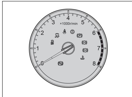
转速表显示发动机在每分钟内的转速。转速的单位是 r/min (转 / 分钟)，发动机转速范围是 0~8000r/min，危险转速范围是 6000~8000r/min。
