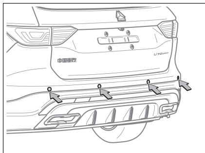
倒车雷达是一种安装在车辆后保险杠上的雷达侦测装置。在倒车及泊车时，通过传感器检测车后是否有障碍物以及障碍物的远近，并利用声音提示，辅助驾驶员安全、轻松的泊车，避免碰撞。
