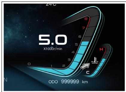
整车电源处于“ON”状态时，显示发动机冷却液的温度。在 C~H 的指示范围内共有 8 段刻度指示，其中“C”表示冷（低温），“H”表示热（高温），根据不同温度点亮相应的格数。当水温表点亮第 7 段刻度指示时，表示发动机冷却液温度过高（温度大于等于 116°C），仪表内的发动机冷却液温度过高报警灯
