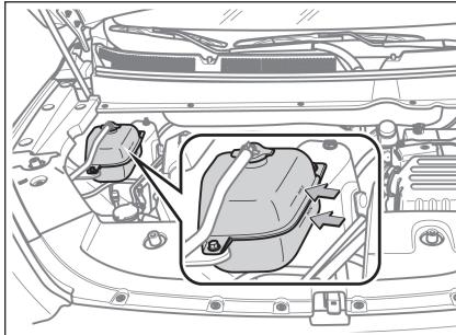
如果发动机冷机时储液壶中的冷却液液位在“MIN”和“MAX”标志线之间，说明冷却液液位正常。
