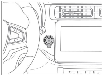
当智能遥控钥匙在车内并在探测区域内，依次按下一键启动按钮，电源状态可在“OFF”→“ACC”→“ON”→“START”（踩下制动踏板）→“OFF”之间循环变换，电源说明如下：
