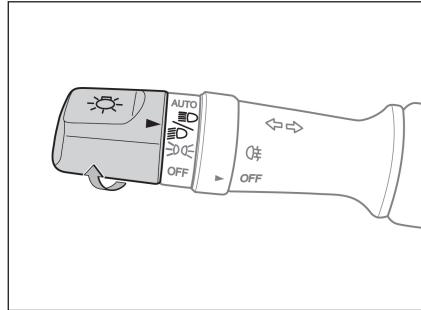
整车电源处于“ON”状态，转动灯光开关末端旋钮至“
