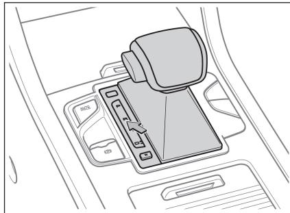
整车电源处于“ON”状态，将换挡操纵手柄挂入“R”挡，倒车灯点亮。退出“R”挡，倒车灯熄灭。
