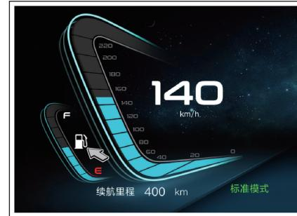
整车电源处于“ON”状态时，显示油箱中的油量。在 E~F 的指示范围内共有 8 段刻度指示，其中“E”表示燃油量为空，“F”表示燃油量为满，根据不同燃油量点亮相应的格数。油量不足时，燃油报警指示灯
