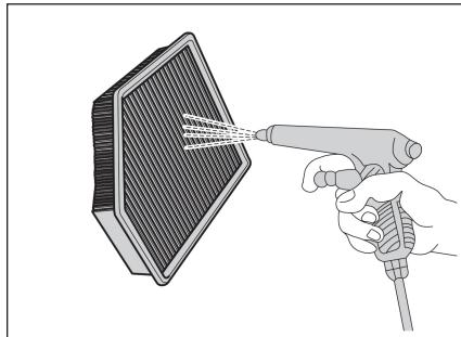
4. 如果空气滤清器滤芯过脏，使压缩空气从滤清器滤芯的正面吹入，直到没有任何杂物吹出为止。
