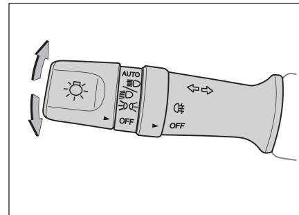
整车电源处于“ON”状态，打开位置灯，转动灯光开关中间的雾灯旋钮至“
