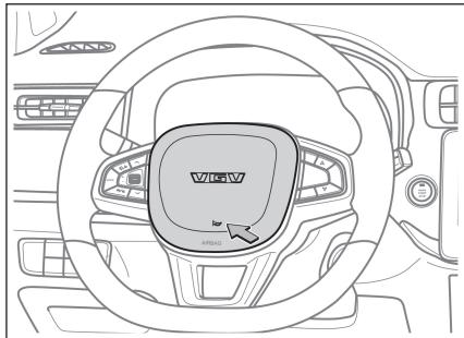
使用汽车喇叭是为了在特殊路段或出现紧急状况时进行提前示警，以保证交通安全。无论整车电源处于任何状态，按下设置在方向盘上的喇叭盖，喇叭都将鸣响。
