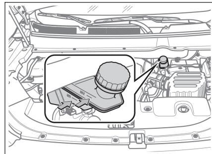
如果储液壶中的制动液液位在“MAX”和“MIN”标志线之间，说明制动液液位正常。
