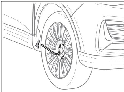
拉起 EPB 电子驻车按键，同时在泄气轮胎对角线方向的轮胎下放置挡块，防止车辆滑动，取出千斤顶，顶起车辆。
