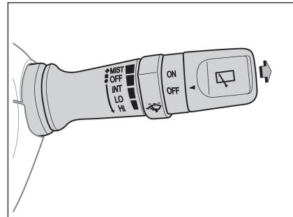
向靠近方向盘方向回拉雨刮操纵杆，前洗涤器喷射洗涤液，同时前雨刮器以低速刮刷。松开操纵杆，洗涤器停止喷射，前雨刮器继续刮刷 3 个循环后停止。
