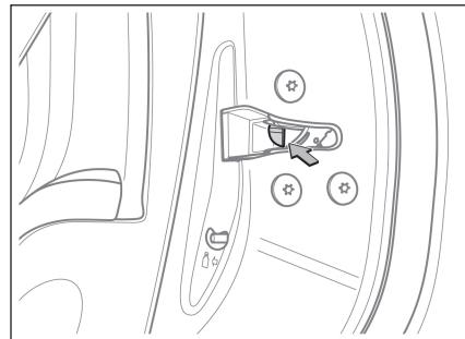
当遥控钥匙电池电量耗尽或中控门锁失效时，机械钥匙只能解锁与闭锁左前门，其余车门可通过下述方式进行解闭锁。
