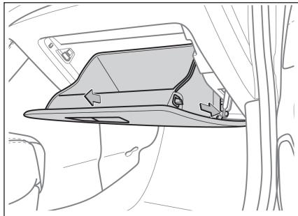
1. 关闭空调，拆卸阻尼器拉杆，向上提出储物箱。
