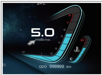
转速表显示发动机在每秒钟内的转速。转速的单位是 r/min(转 / 分钟)，发动机转速范围是 0~8000r/min，危险转速范围是 7000~8000r/min。
