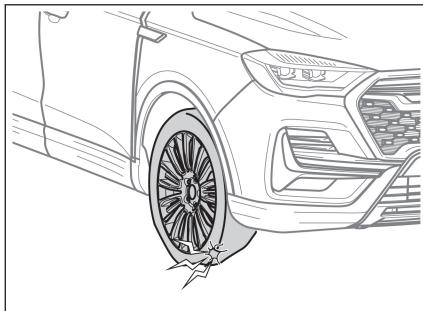
车辆行驶过程中，出现爆胎故障时，应双手紧握方向盘，尽力控制不让方向盘自行转动，轻踩制动踏板，缓慢减速，让车辆沿原方向直线行驶。停车后根据需要进行轮胎更换。
