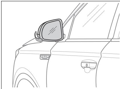
2. 扳动车外后视镜调节开关调整车外后视镜镜片，将车外后视镜镜片调至最佳后视位置。
