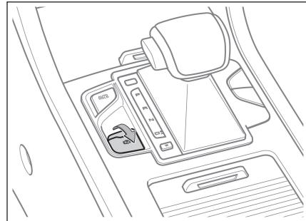
通过操作 EPB 电子驻车按键，实现施加或解除驻车制动。
