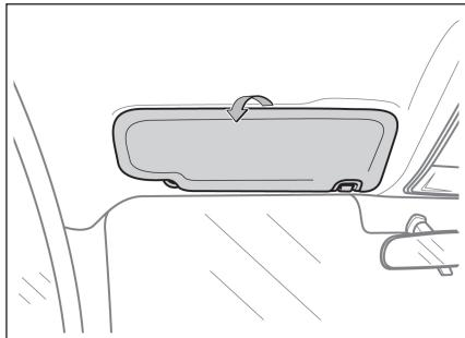
将遮阳板翻下可用来遮挡透过挡风玻璃上部射来的耀眼光线，也可用来遮挡来自侧面的光线。
