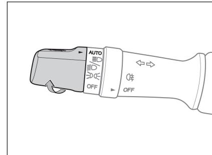
打开近光灯时，向远离方向盘方向推动灯光开关至限位位置，远光灯点亮。再向靠近方向盘方向回拉灯光开关至原始位置，远光灯熄灭。
