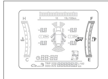
整车电源处于“ON”状态时，显示油箱中的油量。在 E~F 的指示范围内共有 8 段刻度指示，其中“E”表示燃油量为空，“F”表示燃油量为满，根据不同燃油量点亮相应的格数。油量不足时，燃油报警指示灯
