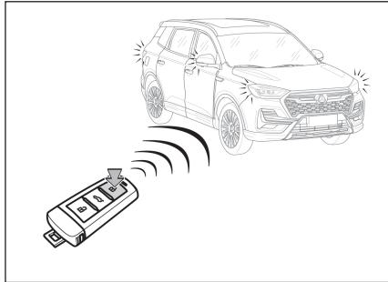
整车电源处于“OFF”状态，且车门关闭，在遥控钥匙作用范围内按下锁止按键，所有车门锁止，整车转向灯闪烁 1 次。
