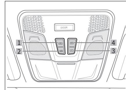
整车电源处于“ON”状态或切换至“OFF”状态 1min 内，操作天窗及天窗遮阳帘按键，可以开启或关闭天窗及遮阳帘。
