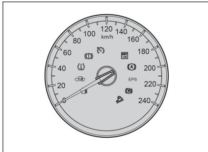
车速表显示车辆的行驶速度，车速的单位是 km/h (千米 / 小时)，最大指示车速是 240km/h。
