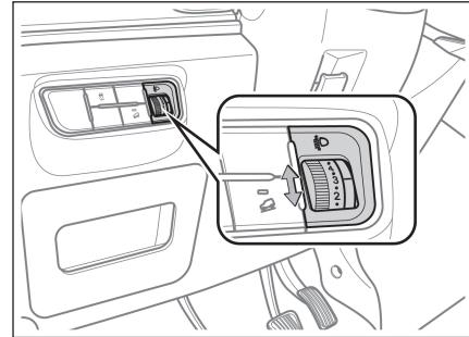
整车电源处于“ON”状态，并且打开近光灯时，如果车辆承重，近光灯光束将向上偏移，为了防止给对面车辆的驾驶员造成眩目，在这种情况下需要调节车辆近光灯光束高度。
