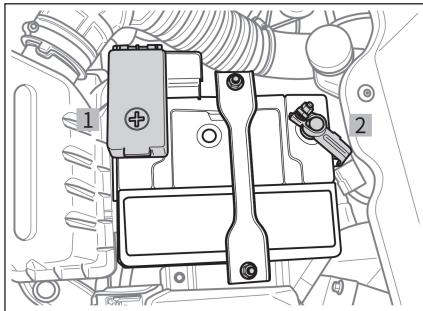
经常检查蓄电池表面与正、负极柱，确保蓄电池表面无裂痕或膨胀，正、负极柱无松动或腐蚀。
