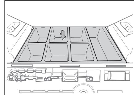
后排座椅折叠后，向前翻起后排座椅，即可使用后排座椅下侧储物盒。
