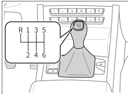
变速器挡位显示在换挡操纵手柄球头上。
