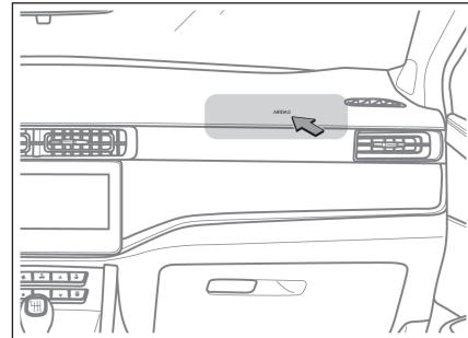
副驾驶室安全气囊安装在仪表板内, 仪表板上标有“AIRBAG”字样。
