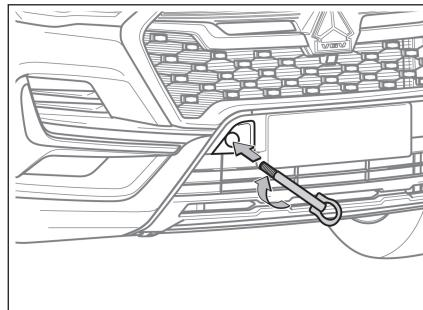
2. 将拖车钩插入拖车孔中，顺时针旋转并轻微拧紧。
