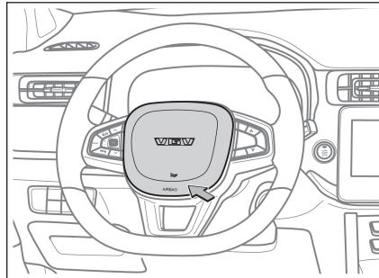
驾驶员安全气囊安装在方向盘内, 方向盘上标有“AIRBAG”字样。
