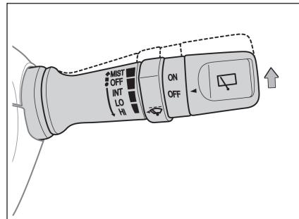
整车电源处于“ON”状态，前挡风玻璃雨刮器和洗涤器工作。从初始位置向下拨动操纵杆，依次为：
