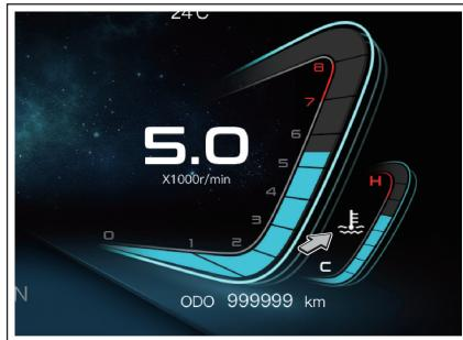
整车电源处于“ON”状态时，显示发动机冷却液的温度。在 C-H 的指示范围内共有 8 段刻度指示，其中“C”表示冷(低温)，“H”表示热(高温)，根据不同温度点亮相应的格数。当水温表点亮第 7 段刻度指示时，表示发动机冷却液温度过高(温度大于等于 116℃)，仪表内的发动机冷却液温度过高报警灯
