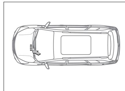
车辆识别代号由制造厂识别代码(WMI)、车辆说明部分(VDS)和车辆指示部分(VIS)三部分组成，共17位字码。
