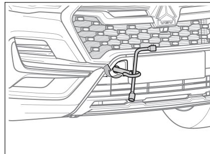
3. 用车轮螺栓套筒拧紧拖车钩。
