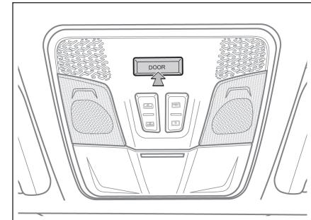
按下“DOOR”开关后，当打开车门时，阅读灯自动开启。关闭车门时，阅读顶灯延迟一段时间后自动熄灭。
