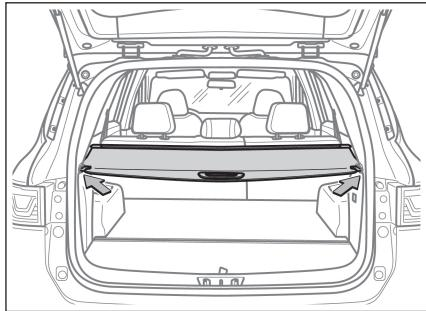
拉动后排遮物帘至卡扣位置稳固固定即可使用后排遮物帘。
